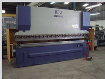
Dobradeira Hidráulica Com capacidade de até # 1/4"x4100
